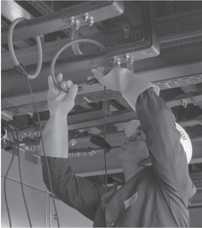
Fig. 40 Typische LEM-flex-Anordnung mit Umwicklung der Stromleiter
